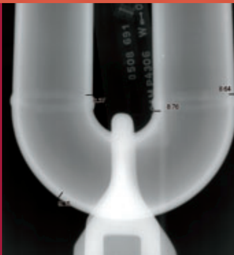
Durchstrahlungsprüfung an einem Rohrbogen
