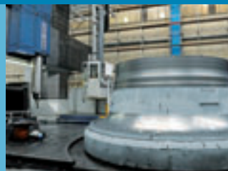
Mechanische Bearbeitung der Mahlschüssel
