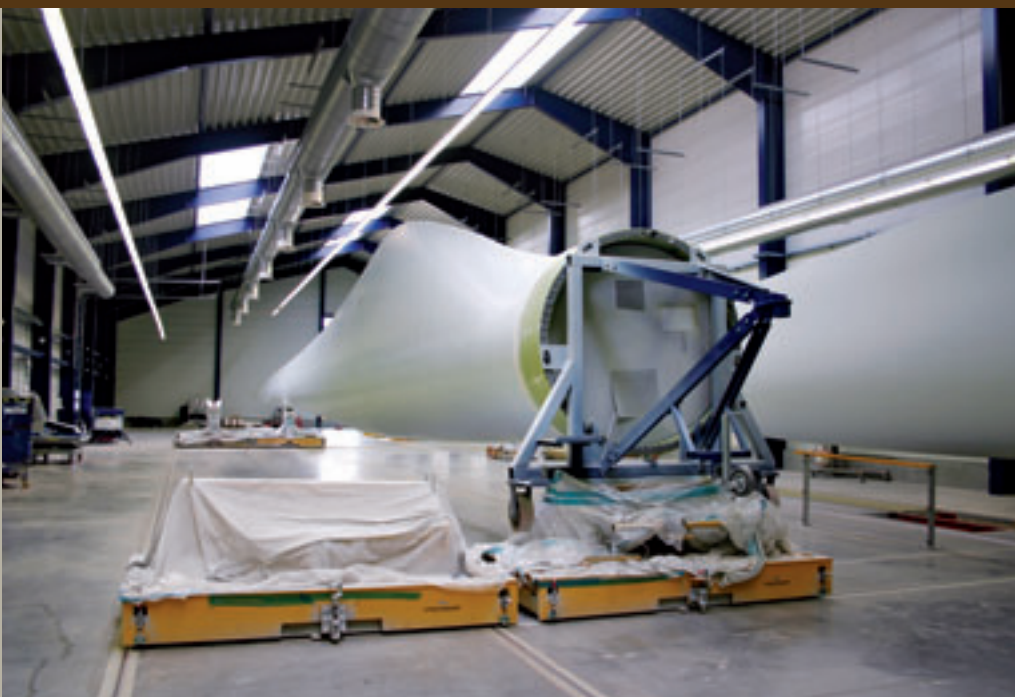
Die Nabe des 44 m langen Flügels hat einen Durchmesser von bis zu 2 m
