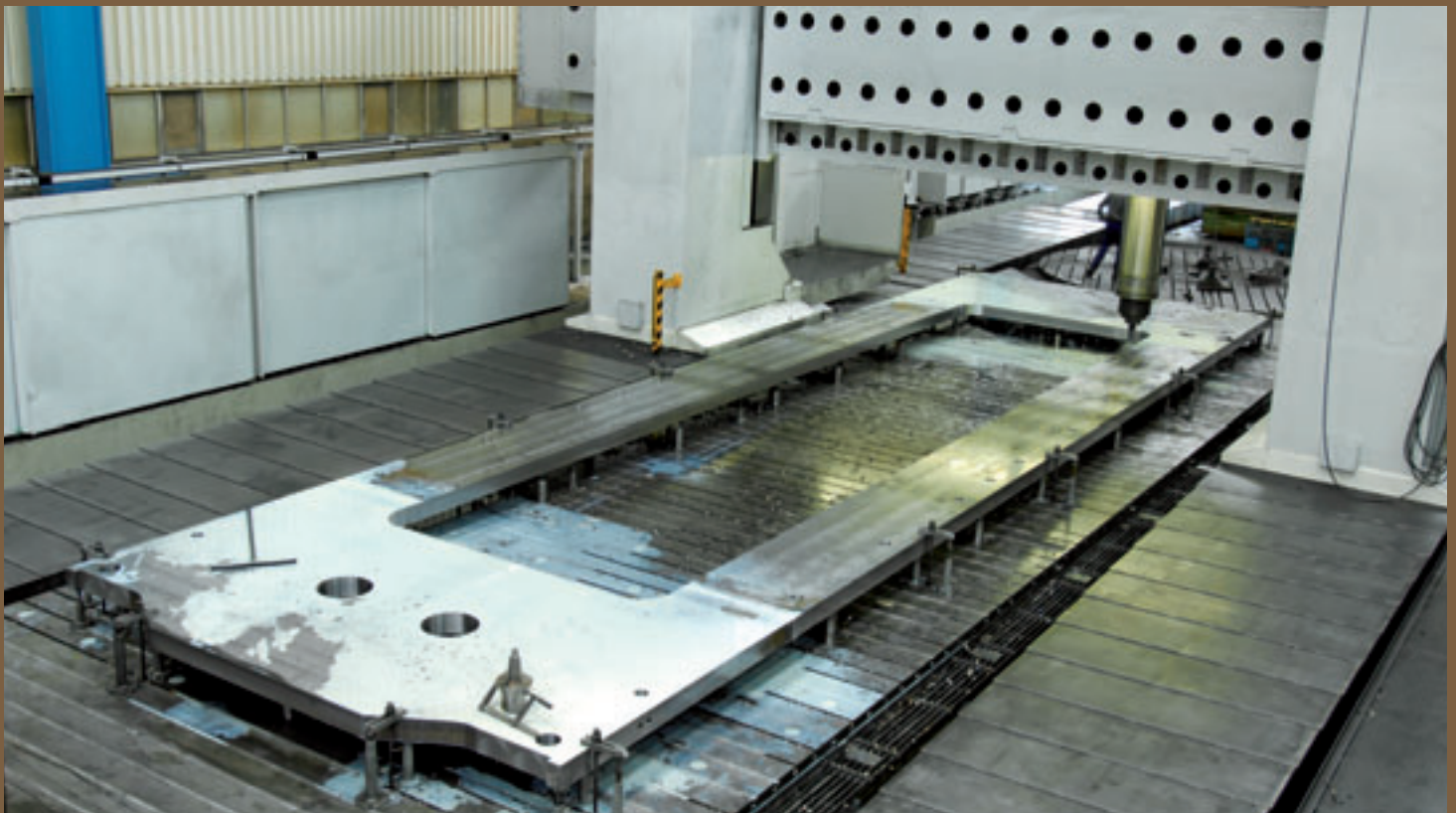
Bearbeitung der Rahmen auf der Schiess im Werk bei Siempelkamp
