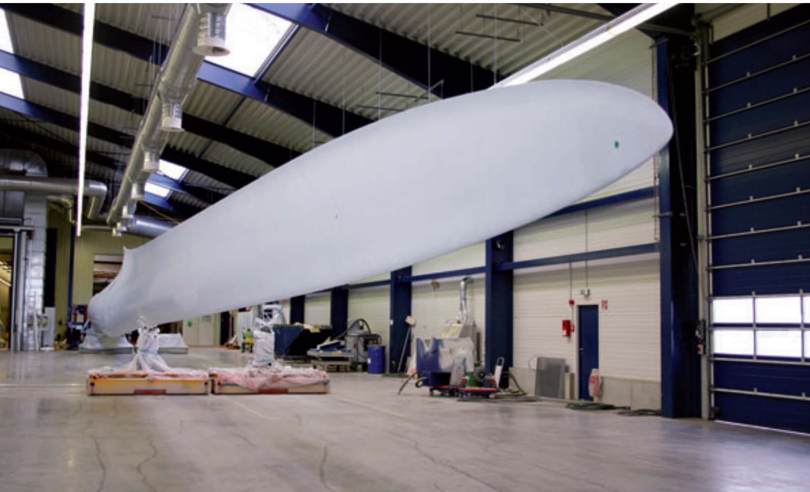
Die Werkstücke werden automatisiert auf der RundSchiene® durch die Lackieranlage gefahren
