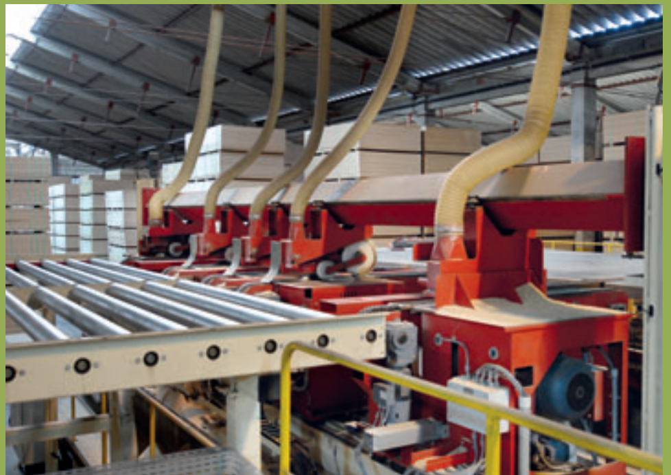
Durchlaufsäge zur neuen Spanplattenanlage
