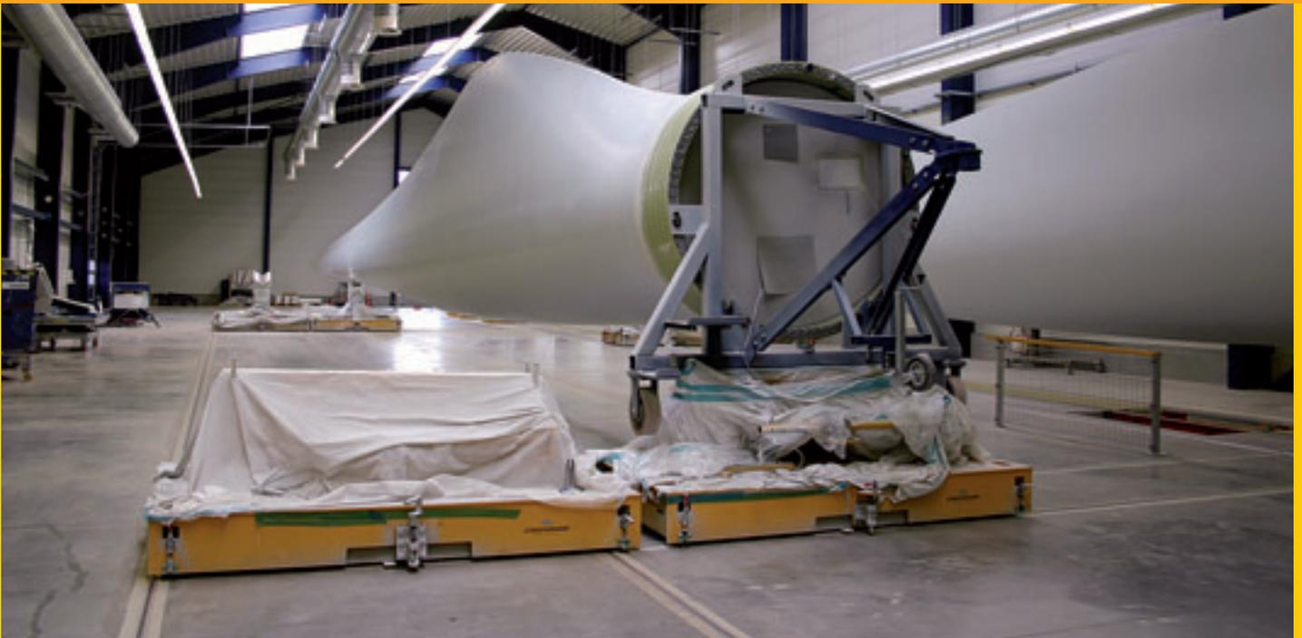
RundSchiene® und Fahrplattformen bei der Herstellung von Rotorblättern
