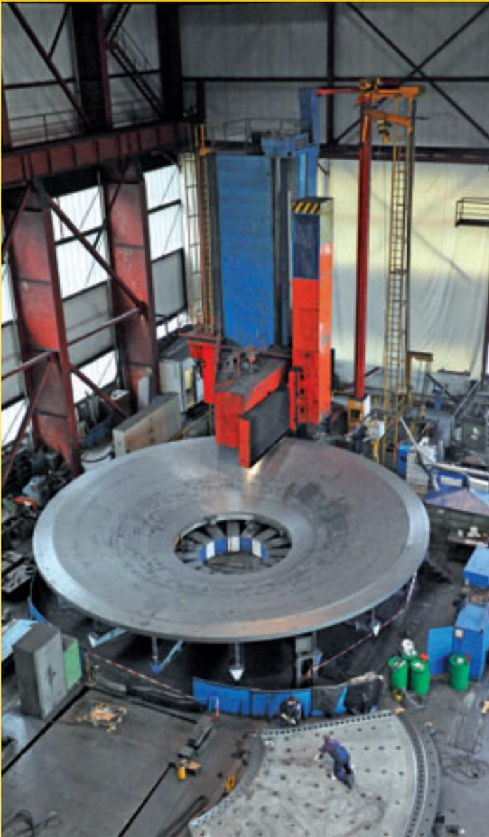
Mechanische Bearbeitung – Mühlenboden auf der Karusselldrehbank
