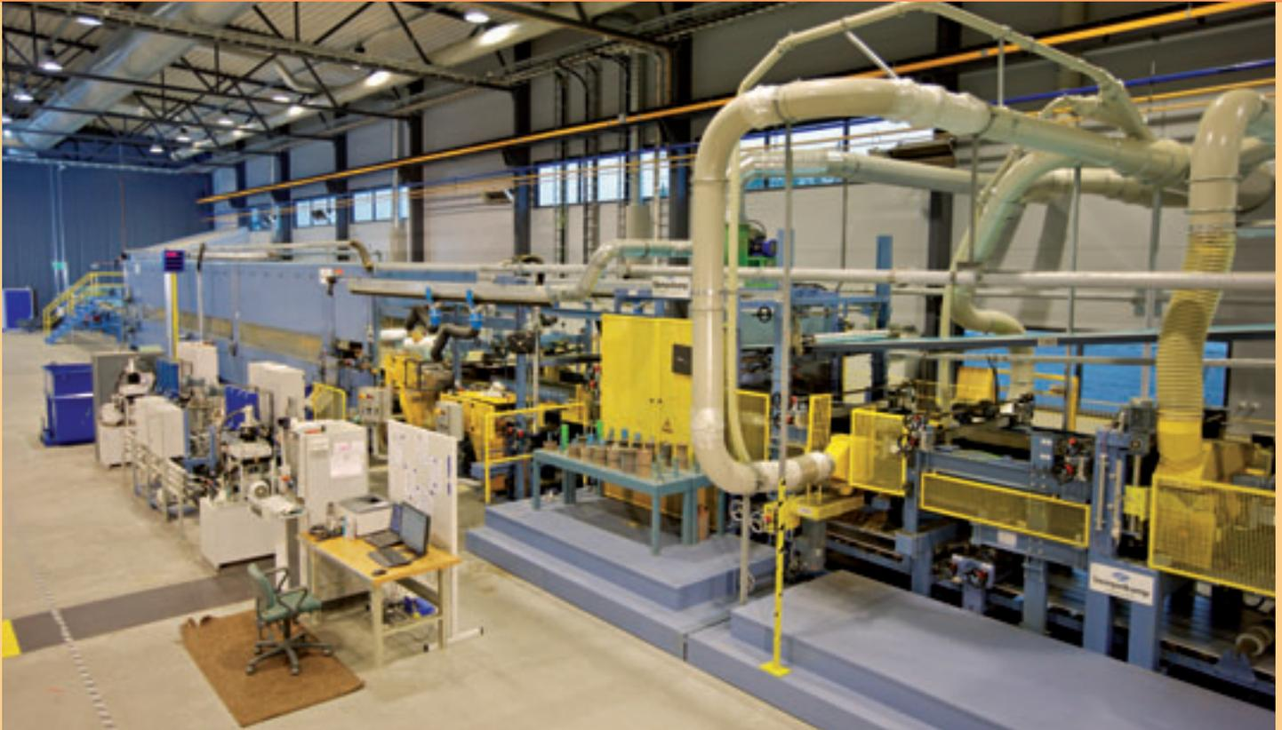
Kleberauftrag und Zusammenführung von Kern und Deckschicht
