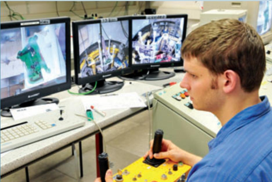
Steuerungswarte für den fernhantierbaren Rückbau
