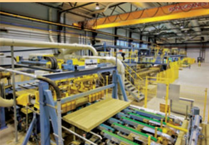
Längsbesäumung der Streifen zur Toleranzkontrolle
