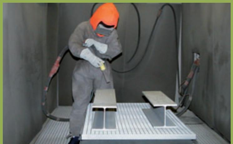
Dekontamination mit dem Stahlkieß-Strahlverfahren für den gezielten Oberflächenabtrag
