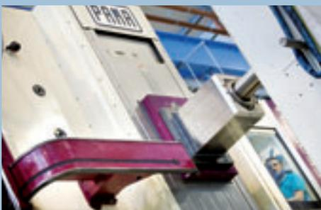
Neu installiert werden zwei weitere Großmaschinen: Aus Italien orderte Siempelkamp ein Platten-Bohr- und -Fräswerk PAMA Speedram 2000. Höchste Präzision, hohe Drehzahlen sowie ein hohes Drehmoment und hohe Antriebsleistung für optimale Zerspanung gehören zu den Qualitätskennzeichen der PAMA-Maschinen.
