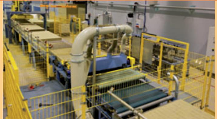
Automatischer Streifenschnitt der Mineralwollplatten
