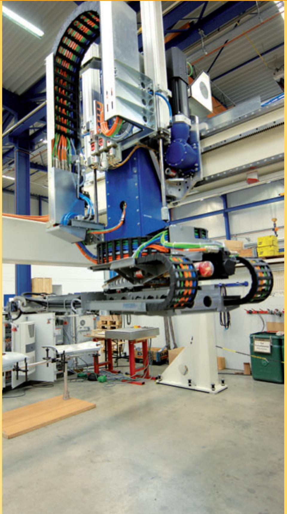
Der FEEDERplus8 im Dauertest
