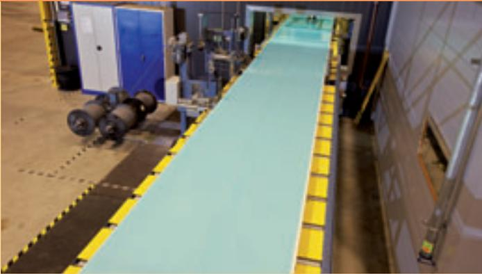
Automatische Zuführung der Dichtstreifen vor der Säge
