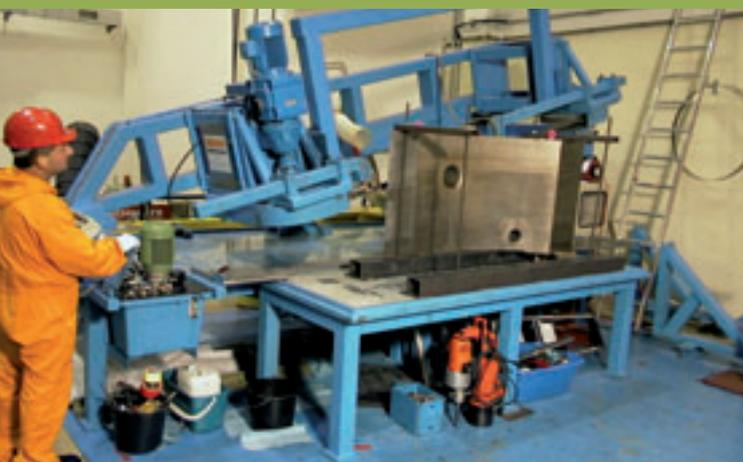
Elektrobandsäge zum Sägen dickwandiger Stahlteile
