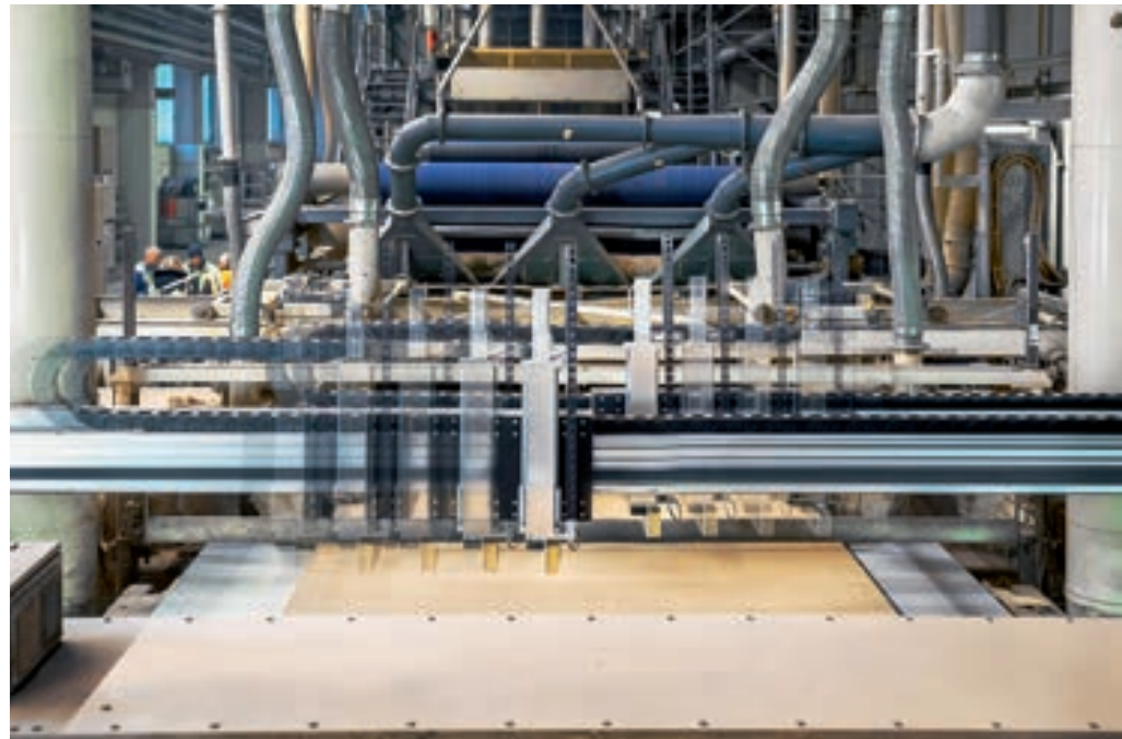
EcoScan-Prototyp mit traversierenden Messköpfen
