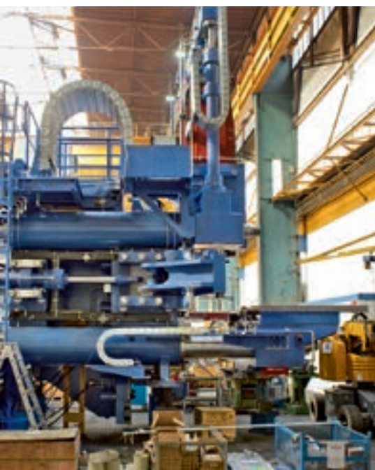
Baugruppenmontage des Radialwalzgerüsts
