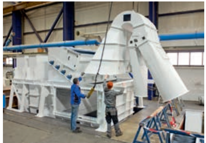
Rechts oben: Aufsetzen des Separierbogens; unten: Einheben der Zellradschleuse
