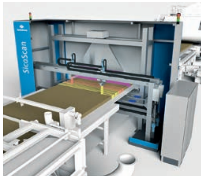
EcoScan-NEO-System mit Flächengewichtsmessung (vorne) und Fremdkörpererkennung (hinten)
