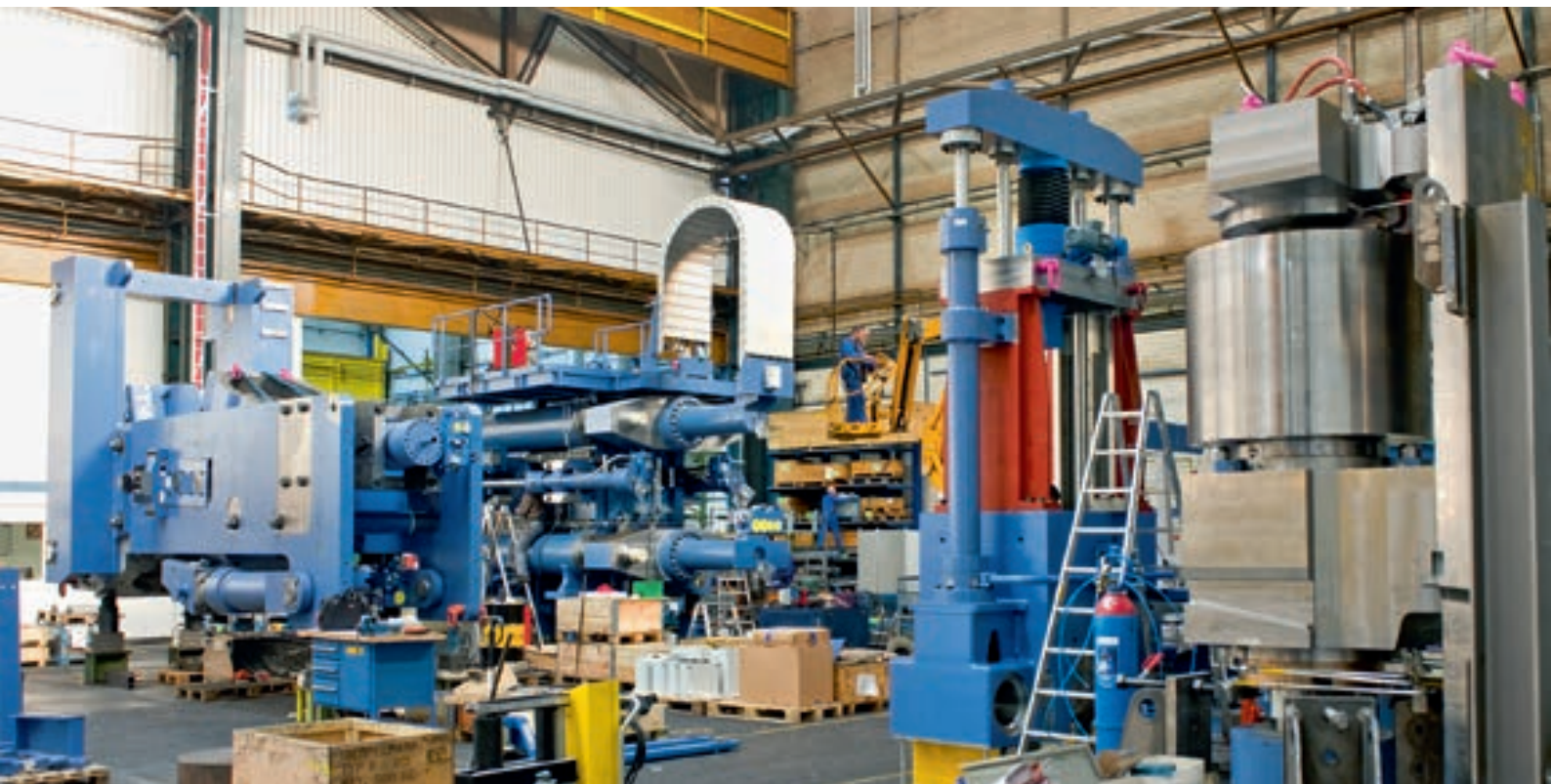
Baugruppenmontage in Krefeld (v. l. n. r.): Axialwalzgerüst, Radialwalzgerüst, oberes Dornwalzenlager mit Dornanhebung und die Hauptwalzenkassette
