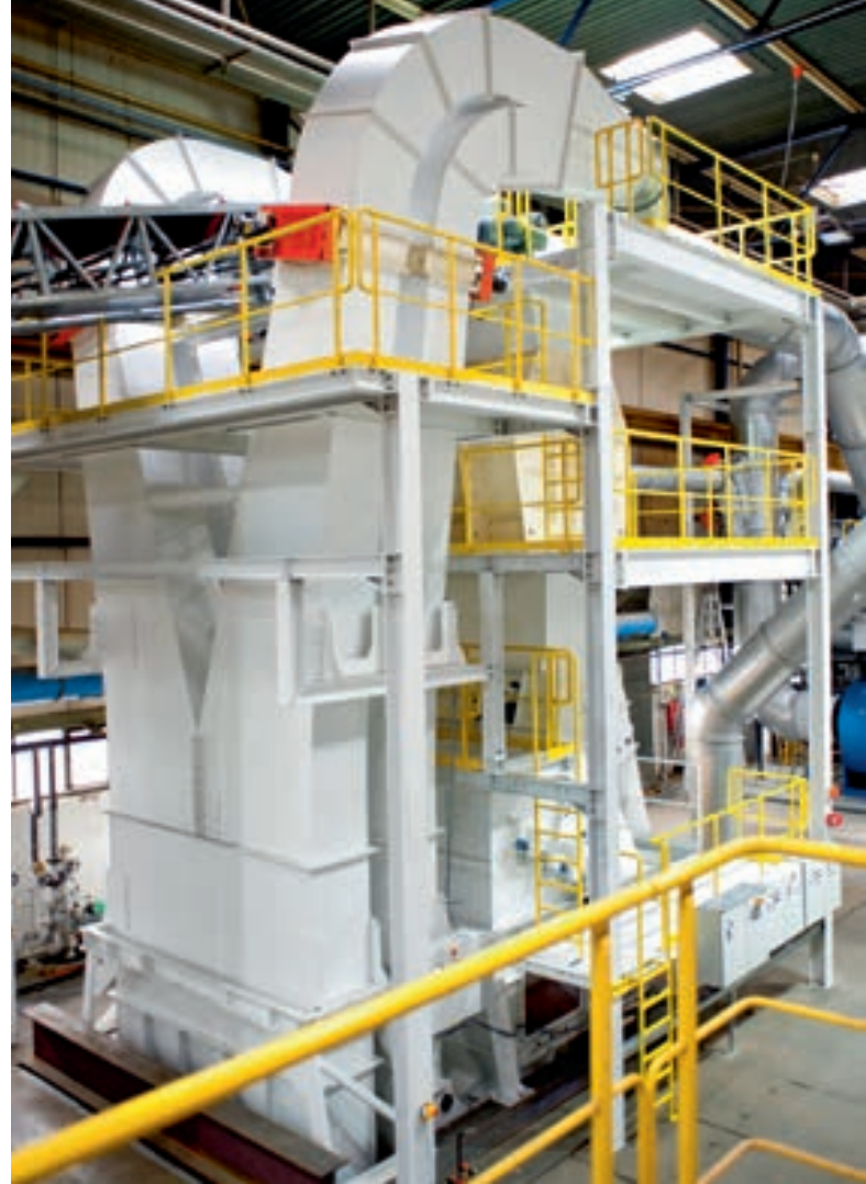
Rückansicht des Sichters mit den beiden Lufteinlässen
